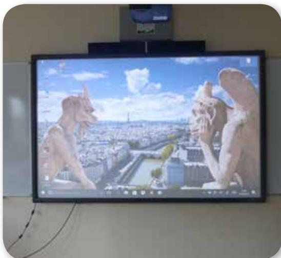
Il est composé d'un écran tactile, sur lequel sont projetées des séquences via un vidéoprojecteur, piloté par un ordinateur. Grâce à un logiciel installé sur la machine, le système prévoit la prise en main sur le grand écran, à l'aide d'un stylet ou des doigts.
